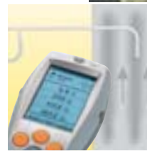
Opcional: medición simultánea de ΔP y m/s para análisis de gases de combustión (p.ej. para cálculo del caudal másico)
