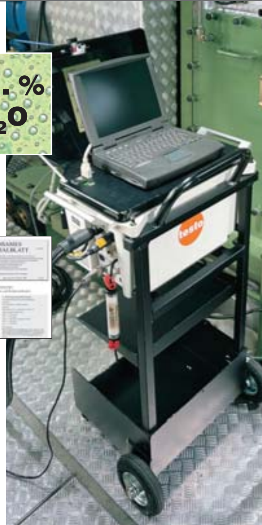
testo 360 - para aplicaciones prácticas fijas como bancos de ensayos de motores, por ejemplo
